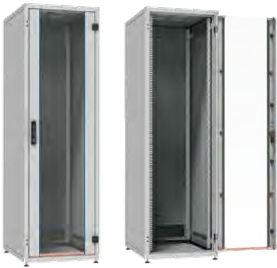
Netzwerkschrank 42HE, Breite 600 mm x Tiefe 800 mm Fronttür Glas 1-teilig, 3-Punkt-Schließung / Rücktür Stahl 1-teilig, 2 x Vorreiber
