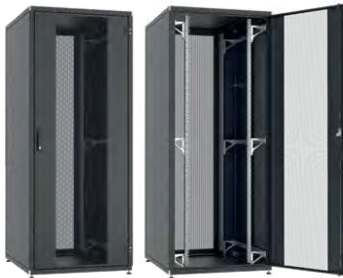
Serverschrank 42HE, Breite 800 mm x Tiefe 1200 mm Front- und Rücktür Stahl, perforiert (80 %), 1-teilig mit Schwenkhebel
